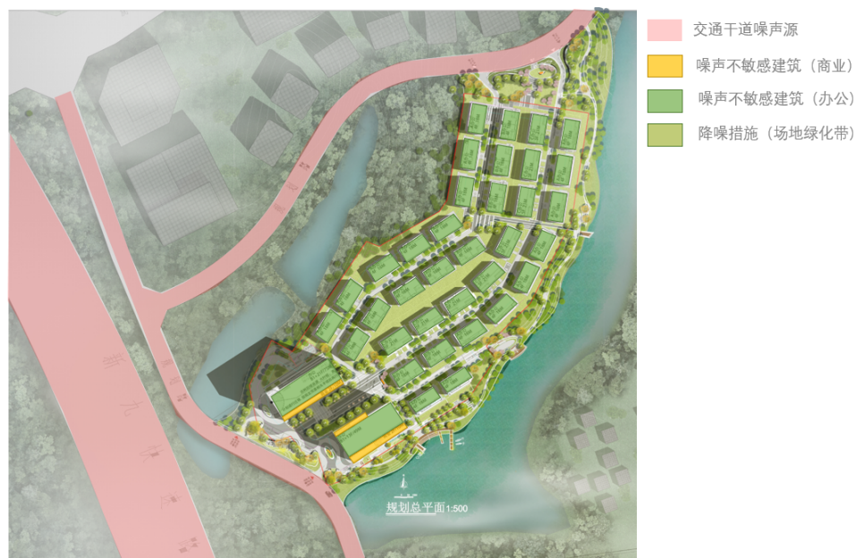
图 4.1.2 场地噪声源分布及建筑规划布局分析图
